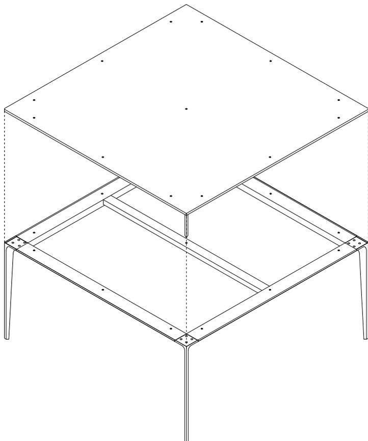
Fissaggio perimetrale / perimetral fixing
