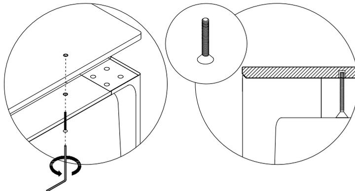
Fissaggio centrale / central fixing
